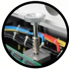
Detector automático de altura para materiales de hasta 100 mm de grosor
