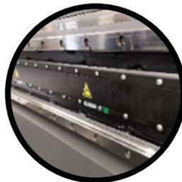
Motor lineal, Rejilla metálica & Guías lineales silenciosas duales
