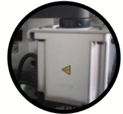
Servomotor de CA de 750w asegura precisión y movimiento X duradero
