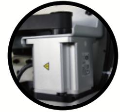
El motor de CA de 750 W garantiza un movimiento X preciso y duradero
