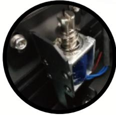
Detector de altura automático para hasta 100 mm de espesor de material
