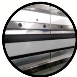
Viga de acero con guías lineales duales
