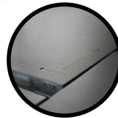
Mesa de vacío precisa con 4 zonas seleccionables, pines de alineación de medios y función de soplado
